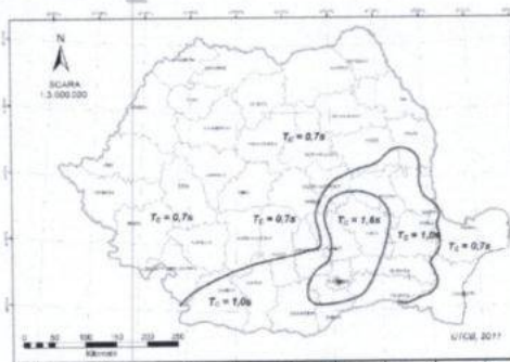
Figura 2 - Zonarea teritoriului României în termeni de perioada de control (colt), T_c a spectrului de raspuns.
